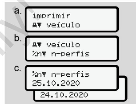
Fig. 98: Sequência de menu de impressão – perfis de rotações
