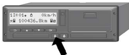
Kuva 54: Kuljettajakortin poistaminen laitteesta
